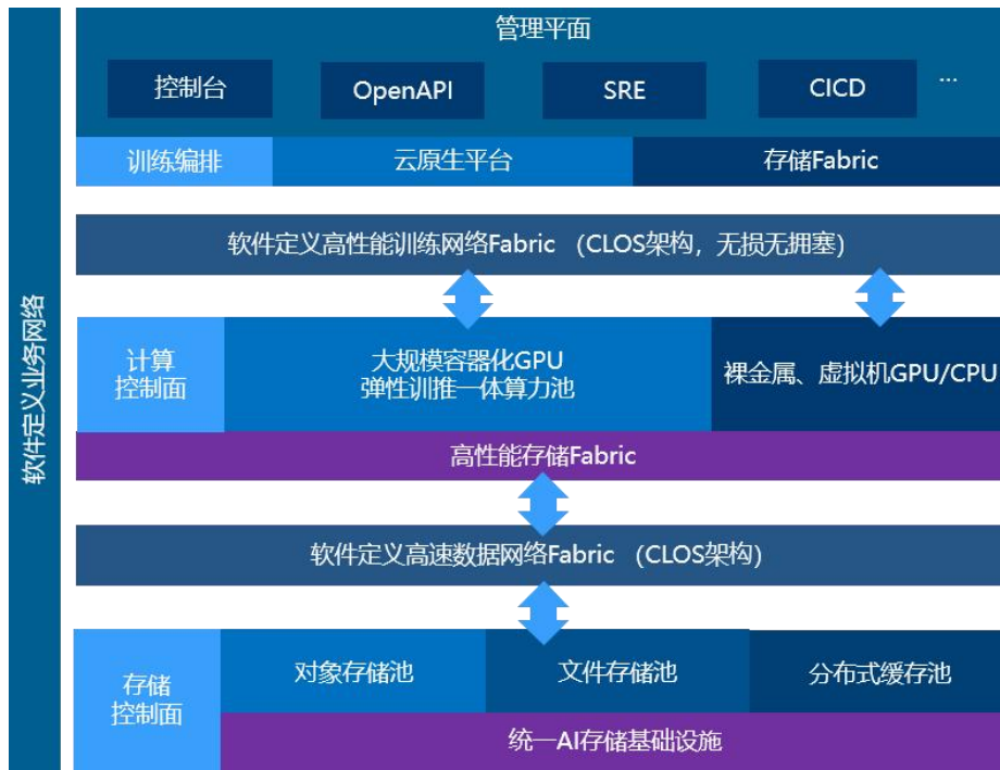
图 21: 商汤大装置构建了面向大模型训练与推理的 AI 原生云算力基础设施
